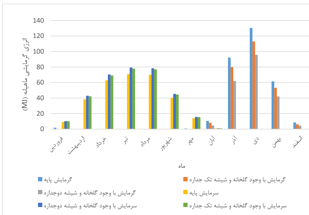
تصویر ۱۰- مقایسه میزان میزان مصرف انرژی ماهیانه در مدل پایه ایوان و تبدیل آن به گلخانه در دو حالت استفاده از شیشه تک جداره و دوجداره (ماخذ: نگارندگان)
