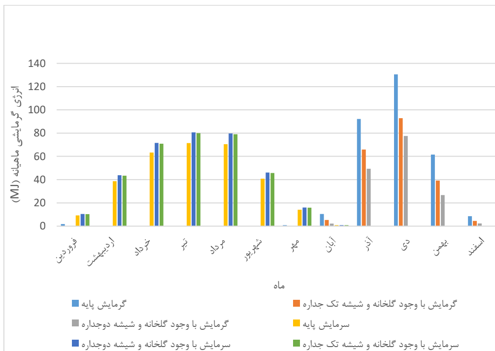
تصویر ۱۲- مقایسه میزان مصرف انرژی ماهیانه در مدل پایه بالکن و تبدیل آن به گلخانه در دو حالت استفاده از شیشه تک جداره و دوجداره (ماخذ: نگارندگان)
