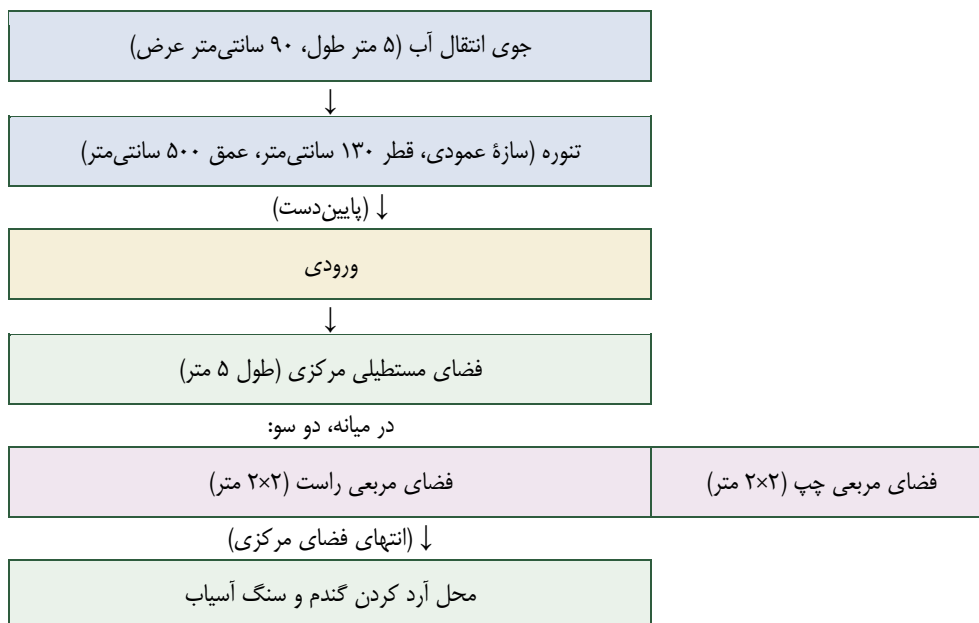
نمودار ۷: دیاگرام آسیاب چلیپایی شکل درمیان
