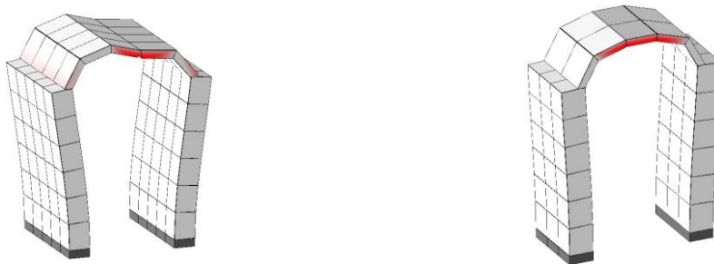
تصویر ۳: توزیع ترک کرنش پلاستیک تحت بار ثقلی در نمونه ایوان خانه‌های صفوی (راست) و آل مظفر (چپ)
