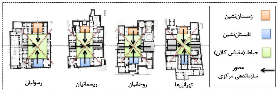
تصویر ۵: سازمان دهنده‌ی حیاط در مقیاس کلان و سازمان گیرندگی تابستان و زمستان‌نشین در مقیاس میانی (مأخذ: نگارندگان)
