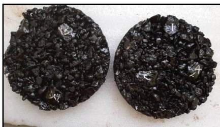
تصویر ۹- نمونه‌ای از نمونه‌های ۱۵ سانتی‌متر آسفالتی
