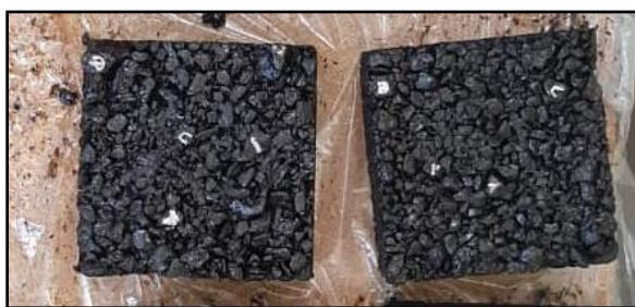
تصویر ۸- نمونه‌ای از نمونه‌های مکعبی آسفالتی
