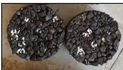
تصویر ۱۰- نمونه‌ای از نمونه‌های ۱۰ سانتی‌متر آسفالتی
