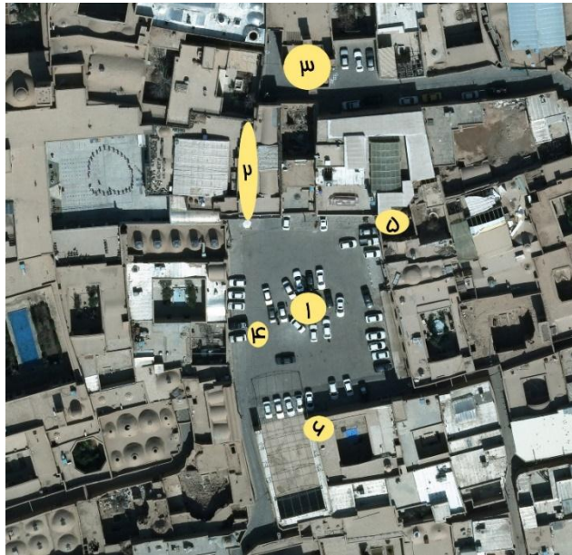
تصویر ۱۵- جانمایی کلی سازه‌های آبی تاریخی میدان وقت و ساعت بر روی عکس هوایی سال ۱۳۹۵-۱) پایاب قنات وقف‌آباد، ۲) آب‌انبار وقت و ساعت، ۳) مخزن و بادگیرهای آب‌انبار وقت و ساعت، ۴) محل ورودی پایاب شاخه شیرین قنات زارچ، ۵) پایاب آله‌آباد، ۶) چاه‌خانه ملک خجسته
